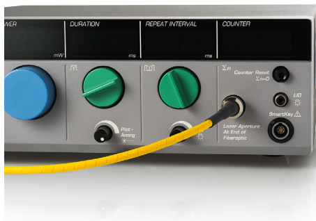
LWL-Kabelanschluss für Laserkonsolen der OcuLight-Serie
